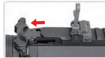
Halando la manija de carga llevará el cerrojo atrás y abrirá la cubierta.
