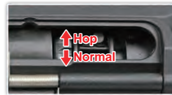
Gire el dial de ajuste hacia la izquierda o hacia la derecha para ajustar hop-up.
